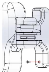
4. Regolare l'inclinazione (da 0° a -30°) e la rotazione orizzontale (180°) e fissare il tutto con la vite centrale
