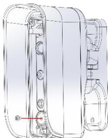
9. Dopo aver eseguito la taratura inserire il coperchio del sensore e chiudere il tutto con la vite posta sotto ad esso
